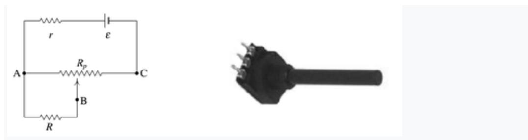
Diagrama de circuito de um divisor de voltagem e fotografia de um potenciômetro.
