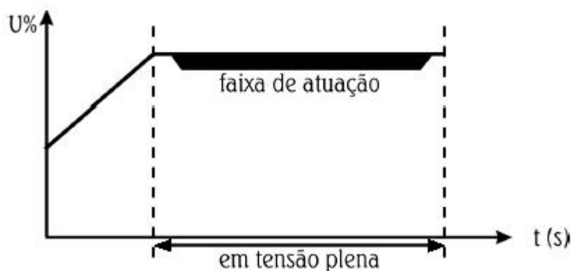
Figura 9 – Economia de energia usando um soft-starter
