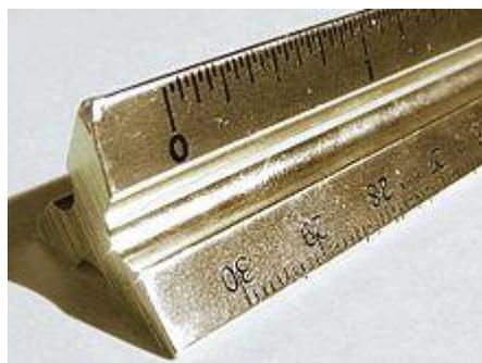
O escalímetro é um instrumento na forma de um prisma triangular que possui seis réguas com diferentes escalas. É utilizado para medir e conceber desenhos em escalas ampliadas ou reduzidas.
