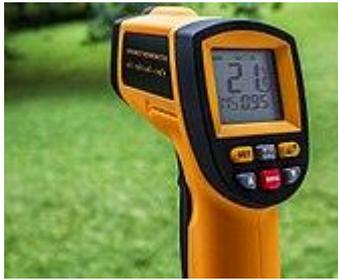
O pirômetro é um tipo de termômetro. É um equipamento que mede irradiação térmica da superfície de um objeto e informa a temperatura. Diferentes tipos de pirômetros foram desenvolvidos pelo homem – hoje se trata de um dispositivo que não necessita de contato, contrastando com outros meios de obter informação sobre a temperatura de um objeto, como o termopar e uma termorresistência.
