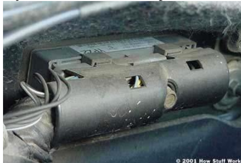
O conector na unidade de controle do motor possui mais de 100 fios
