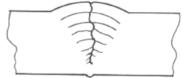
A fissuração a quente também é fortemente influenciada pela direção de solidificação na solda. Quando grãos de lados opostos crescem juntos numa forma colunar, impurezas e constituintes de baixo ponto de fusão podem ser empurrados na frente de solidificação para formar uma linha fraca no centro da solda.
