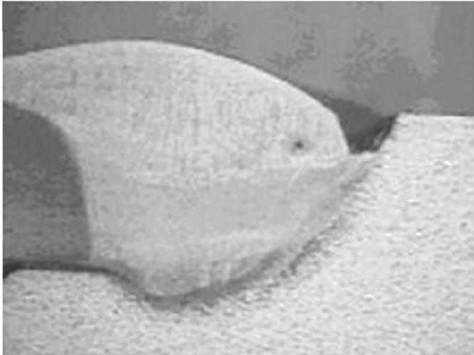
Esses são defeitos comuns fáceis de se evitar. A causa pode ser uma corrente de soldagem muito baixa ou uma velocidade de soldagem inadequada.
