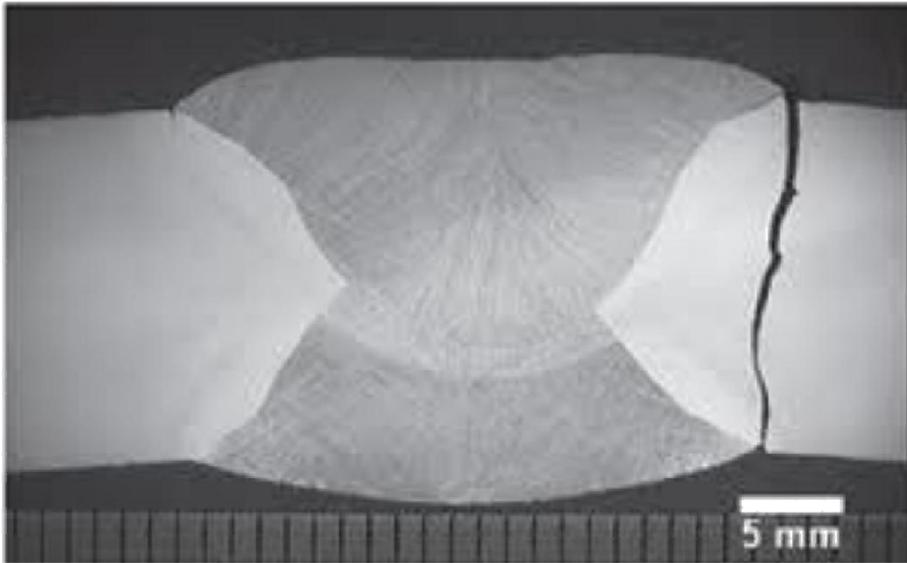
Figura 2. Trincas por fadiga adjacente a solda [8].
