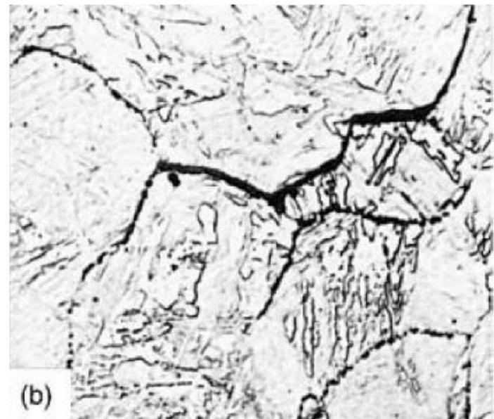
Trincas de reaquecimento em aço CrMoV
