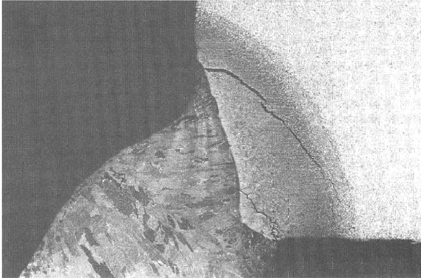
Trincas por hidrogênio na zona termicamente afetada numa junta em ângulo feita com um eletrodo rutílico.
