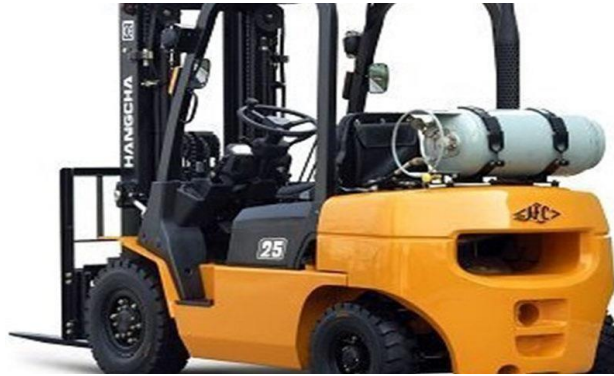
Figura 20: Empilhadeira de combustão a gás GLP Fonte: www.solucoesindustriais.com.br
