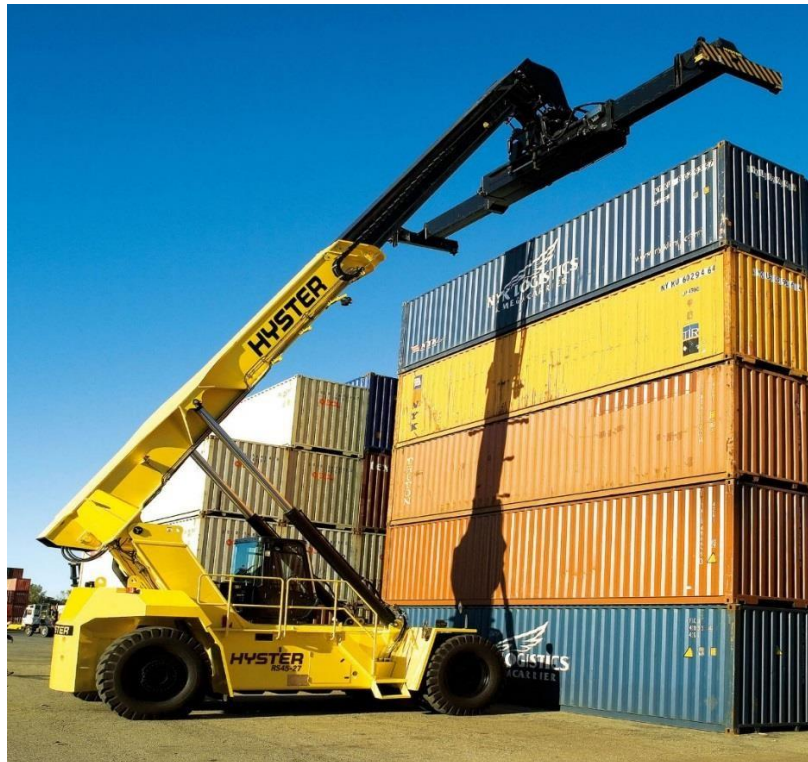
Figura 19: Empilhador de Alcance de ContêinerCHEIOS HYSTERH40.00-50.00XM-16CH Fonte: https://www.solucoesindustriais.com.br
