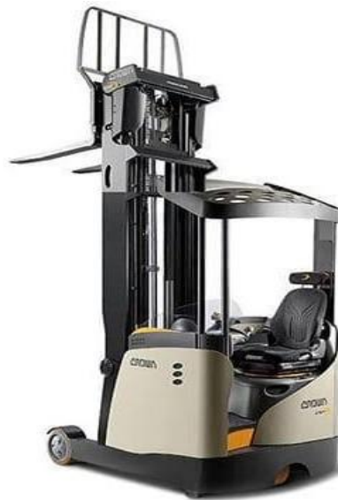
Figura 11: Empilhadeira de Mastro Retrátil Elétrica Para Armazém Frigorífico
