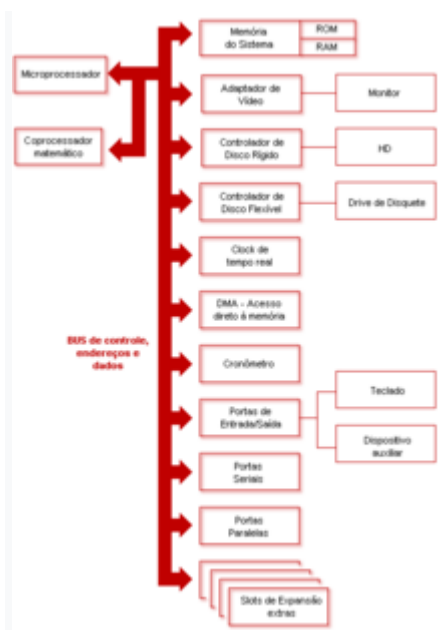
Blocos funcionais de um computador.
