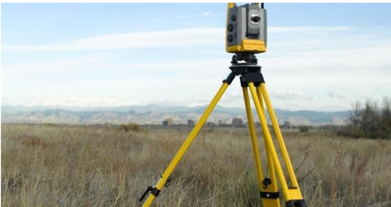
*Etapas de um projeto de arquitetura: levantamento topográfico planialtimétrico*
