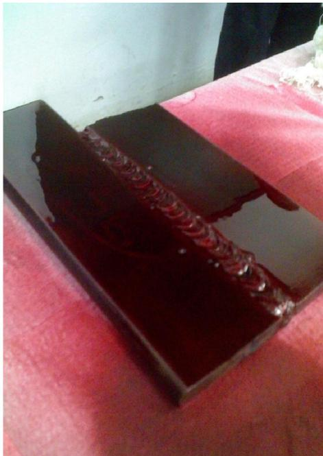
Figura 1 – Aplicação do líquido penetrante
