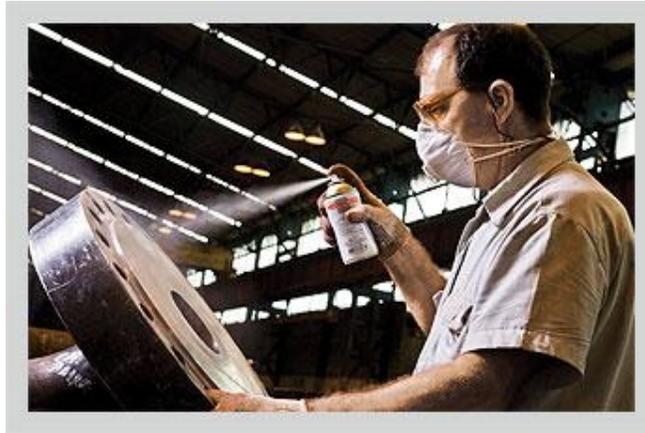
O ensaio por Líquidos Penetrantes é considerado um dos melhores métodos de teste para detectar descontinuidades superficiais de materiais isentos de porosidade, como: metais ferrosos e não ferrosos, alumínio, ligas metálicas, cerâmicas, vidros, certos tipos de plásticos ou materiais organo-sintéticos. Líquidos penetrantes também são utilizados para a detecção de vazamentos em tubos, tanques, soldas e componentes.
