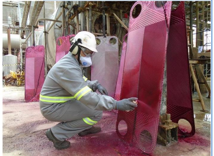
O ensaio por Líquidos Penetrantes é considerado um dos melhores métodos de teste para detectar descontinuidades superficiais de materiais isentos de porosidade, como: metais ferrosos e não ferrosos, alumínio, ligas metálicas, cerâmicas, vidros, certos tipos de plásticos ou materiais organo-sintéticos.
