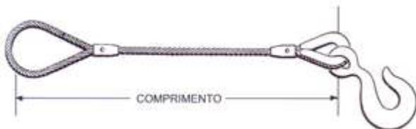
O laço de cabo de aço tipo CF9 é um versátil laço de cabo de aço com gancho e sapatilha acoplado nem uma das extremidades e na outra um olhal normal. Sua aplicação é geral para sentidos verticais e horizontais. Eficientes para uso em diversos tipos de tração ou elevação de cargas. O **fator de segurança 5:1** já é aplicado na produção deste tipo de laço.
