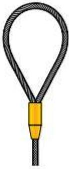
**Olhal tipo 1** - Trançado flamenco prensado com presilha de aço. Este é o tipo de olhal mais seguro e indicado pela BBA, pois parte da resistência do olhal é dado pelo trançamento e não apenas pela presilha pensada.
