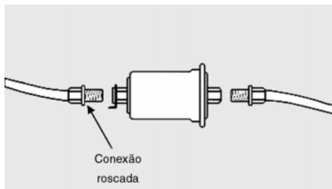
Prisioneiro de conexão Para filtros com carcaça metálica.
