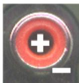
é encontrada na saída de tape decks, aparelhos de CD (do tipo não portátil) e os, já quase obsoletos, toca-discos de vinil. Por oferecer apenas dois contatos este plug não conduz sinais balanceados e geralmente indica que o equipamento que o utiliza não é destinado ao uso profissional. Obs.3: Alguns fabricantes de equipamento de alta qualidade, e plenamente
