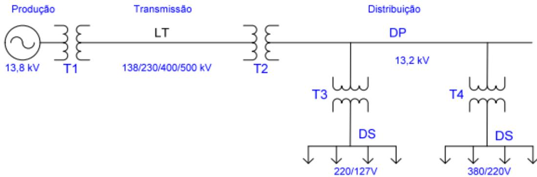
**Produção** A geração industrial de energia elétrica pode ser realizada por meio do uso da energia potencial da água (geração hidrelétrica) ou utilizando a energia potencial dos combustíveis (geração termoelétrica). No Brasil, cerca de 90% da energia gerada são através de hidrelétricas, porque o nosso País possui um rico potencial hidráulico, estimado em mais de 150 milhões de kW.
