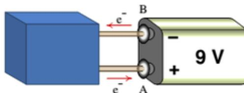
Numa pilha química ligada a um condutor externo, saem eletrões do elétrodo negativo e entram no elétrodo positivo
