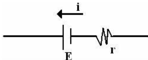
Equação para um gerador real, devido à resistência interna a perda de energia se dará por:
