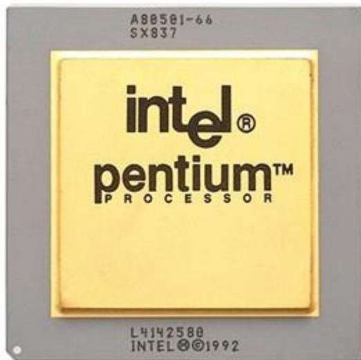
Processador Intel Pentium A80501, de 66 MHz (Fonte da imagem: Wikimedia Commons )
