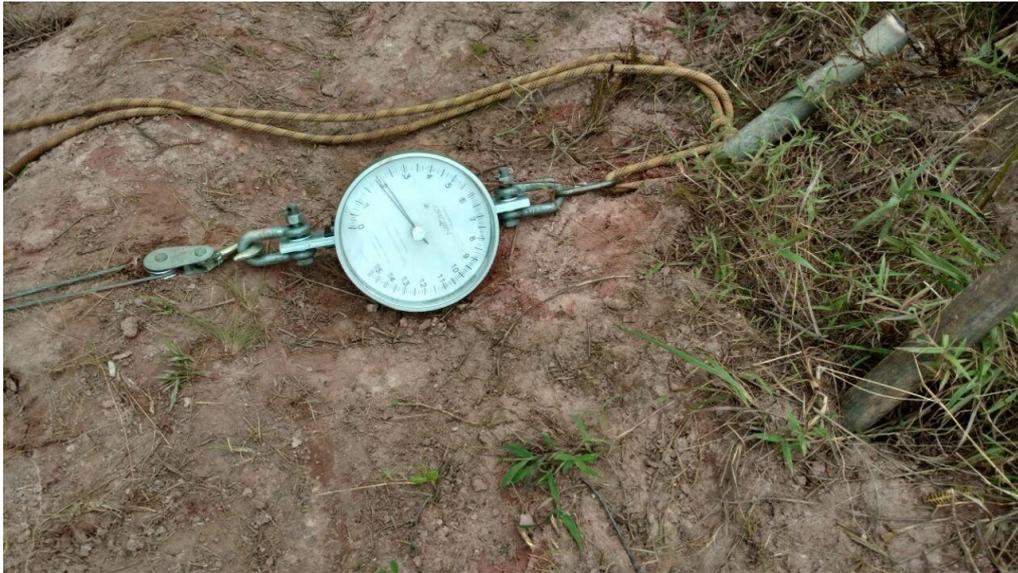
Deverá ser realizada análise do solo, por engenheiro de preferencia com conhecimento civil geotécnico para instalação das ações que deverão ser fixados no mínimo a 1,20 m da crista do solo com aplicação de calda de cimento para fixação das hastes, para garantir a rigidez da mesma.
