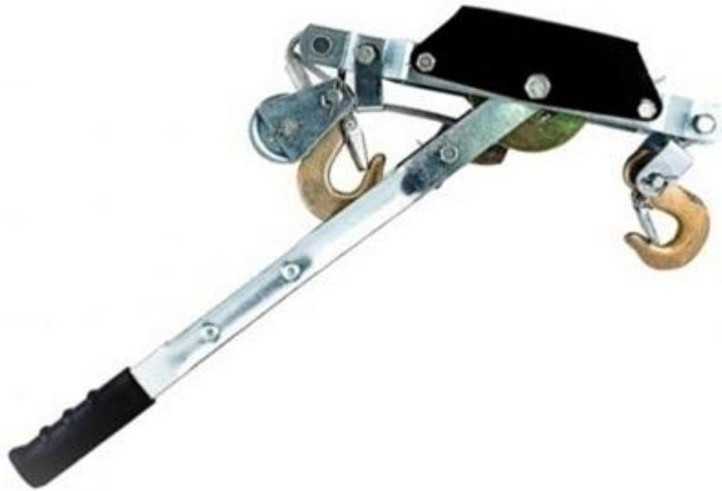
7.5) Começar a macaquear a talha com movimentos alternados a fim de reagir a estrutura a estaca de reação.
