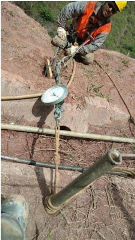
Teste de pontos de ancoragens feitos com tubos galvanizados de 1,5 metro, afixadas no terreno com dois pontos.
