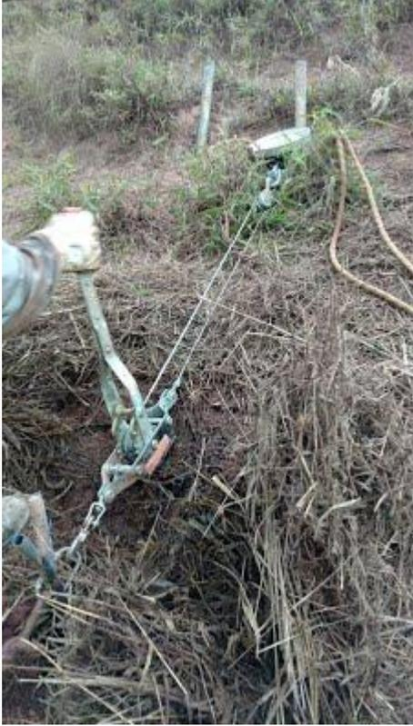
7.3) Conectar a talha entre a estaca de reação e a estaca a ser ensaiada:
