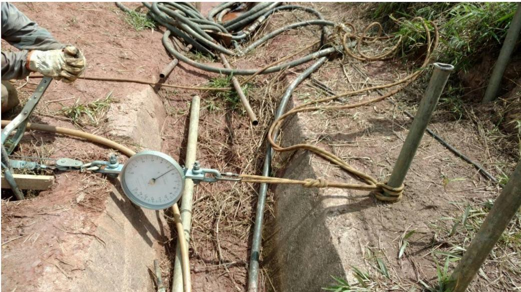
Foi aplicado sistema de carga progressiva sobre os tubos, realizando-se ligeiras pausas para verificação do comportamento do sistema de ancoragem
