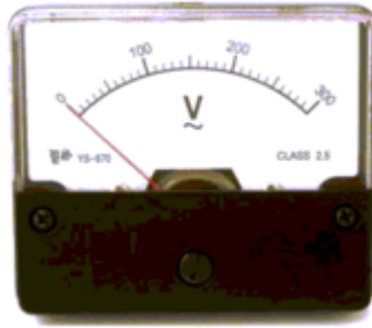
Voltímetro analógico utilizado em painéis elétricos
