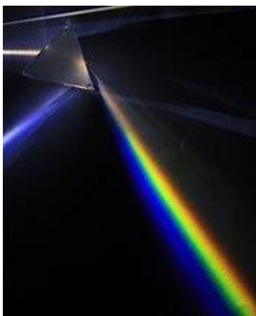
Um prisma triangular dispersando a luz branca
