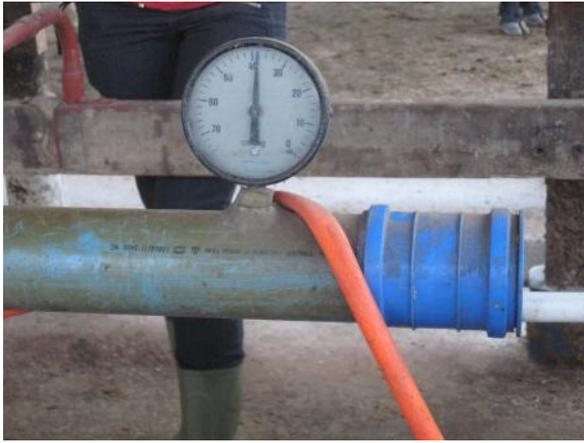
Figura 11: Registro de intensidade de vácuo.
