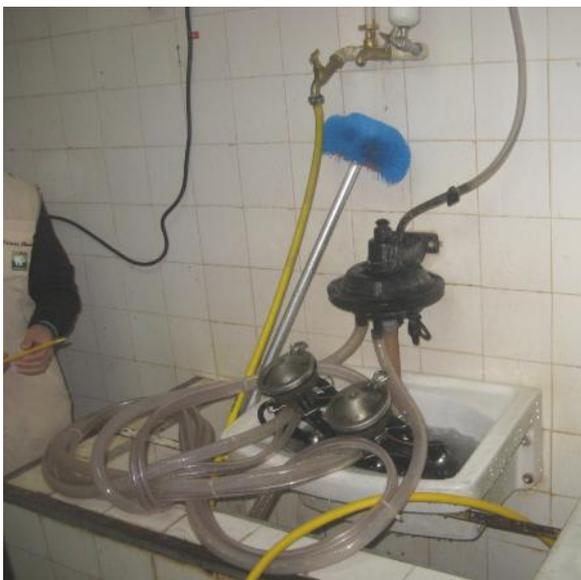
Figura 18: Sistema de limpeza
