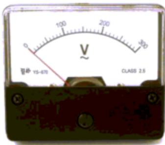
Voltímetro analógico utilizado em painéis elétricos
