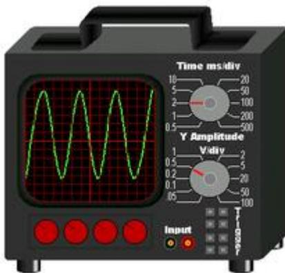
Um típico osciloscópio é uma caixa retangular com uma tela, conectores de entrada, knobs para controle e botões na frente do painel. Atualmente existem osciloscópios fixos com tela de cristal sólido
