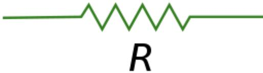
Diagrama de circuito para uma resistência.
