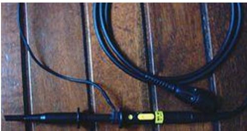
Ponta de prova de um osciloscópio.
