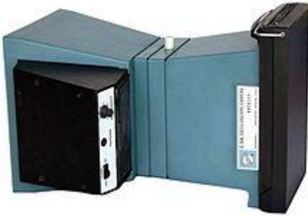
Câmera de osciloscópios da Tektronix® Modelo C-5A com pacote de filmes Polaroid instantâneos atrás.
