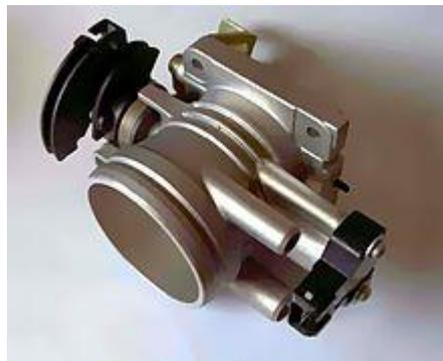
Corpo de borboleta: o sensor de posição da borboleta é montado no eixo da mesma.
