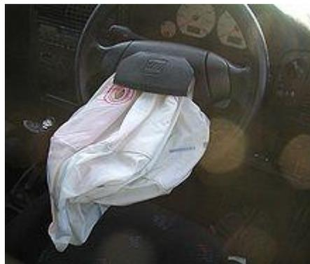
Um airbag automotivo infla e desinfla em uma fração de segundo (cerca de 0,8 segundos).
