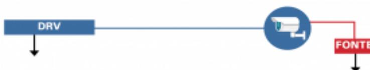
No caso acima, os pontos de terra podem ser diferentes, o que pode causar uma diferença de potencial entre o terra do DVR e o terra da fonte e onde existe diferença de potencial, existirá a circulação de uma corrente AC, na frequência da rede, 60 Hz.
