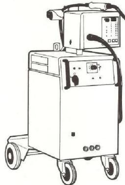
*Exemplo de uma fonte de potência para solda (Máquina de soldar)*
