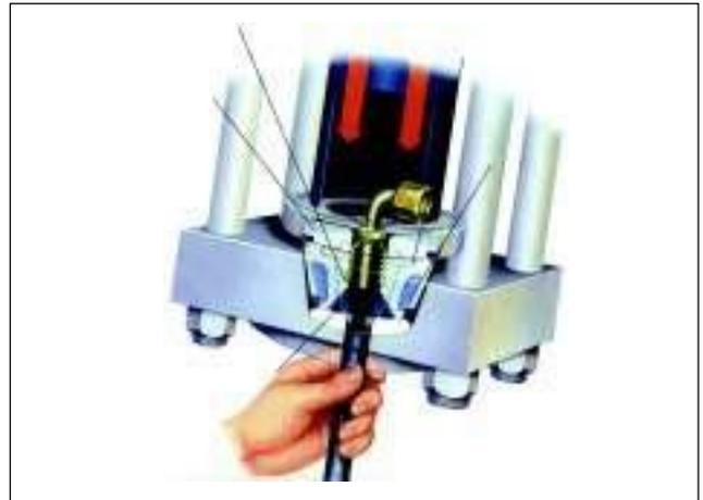
Classificam-se como conexões permanentes todas aquelas cujo sistema de fixação da conexão à mangueira não permite reutilizar a conexão quando a mangueira se danifica. Este tipo de conexão necessita de equipamentos especiais para montagem.
