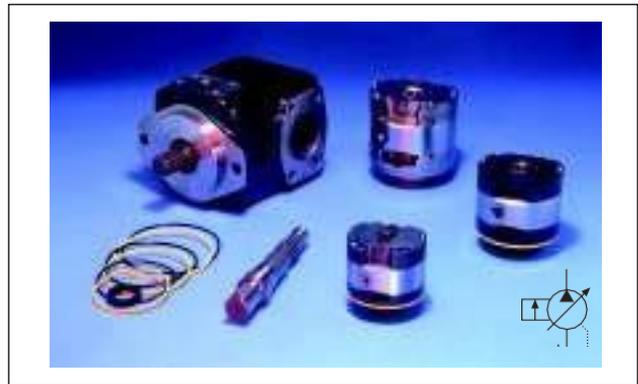
As bombas de palheta produzem uma ação de bombeamento fazendo com que as palhetas acompanhem o contorno de um anel ou carcaça. O mecanismo de bombeamento de uma bomba de palheta consiste de: rotor, palhetas, anel e uma placa de orifício com aberturas de entrada e saída.
