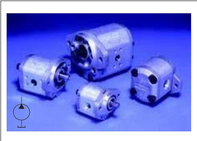
A bomba de engrenagem consiste basicamente de uma carcaça com orifícios de entrada e de saída, e de um mecanismo de bombeamento composto de duas engrenagens. Uma das engrenagens, a engrenagem motora, é ligada a um eixo que é conectado a um elemento acionador principal. A outra engrenagem é a engrenagem movida.
