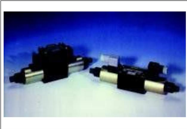
As válvulas de controle direcional consistem de um corpo com passagens internas que são conectadas e desconectadas por uma parte móvel. Nas válvulas direcionais, e na maior parte das válvulas hidráulicas industriais, conforme já vimos, a parte móvel é o carretel. As válvulas de carretel são os tipos mais comuns de válvulas direcionais usados em hidráulica industrial.
