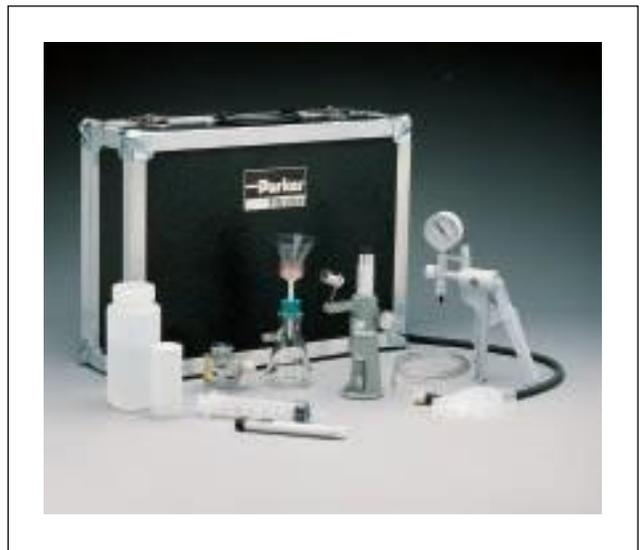
O Teste de Membrana não é nada mais que uma análise visual de uma amostra do fluido. Normalmente compõe-se da tomada de uma amostra do fluido e de sua passagem por um meio filtrante de membrana. A membrana é então analisada por microscópio para cor e conteúdo e comparada aos padrões ISO. Usando esta comparação, o usuário pode ter uma estimativa "passa, não-passa" do nível de pureza do sistema.
