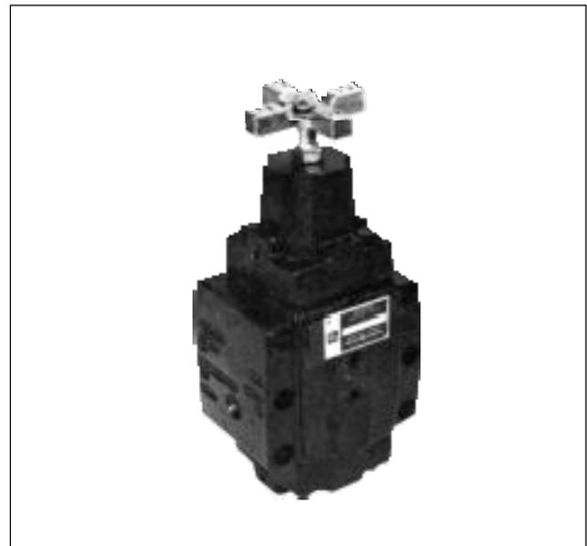
Uma válvula de descarga é uma válvula de controle de pressão normalmente fechada operada remotamente, que dirige fluxo para o tanque quando a pressão, numa parte remota do sistema, atinge um nível predeterminado.
