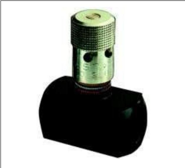
A função da válvula controladora de vazão é a de reduzir o fluxo da bomba em uma linha do circuito. Ela desempenha a sua função por ser uma restrição maior que a normal no sistema. Para vencer a restrição, uma bomba de deslocamento positivo aplica uma pressão maior ao líquido, o que provoca um desvio de parte deste fluxo para outro caminho. Este caminho é geralmente para uma válvula limitadora de pressão, mas pode também ser para outra parte do sistema.
