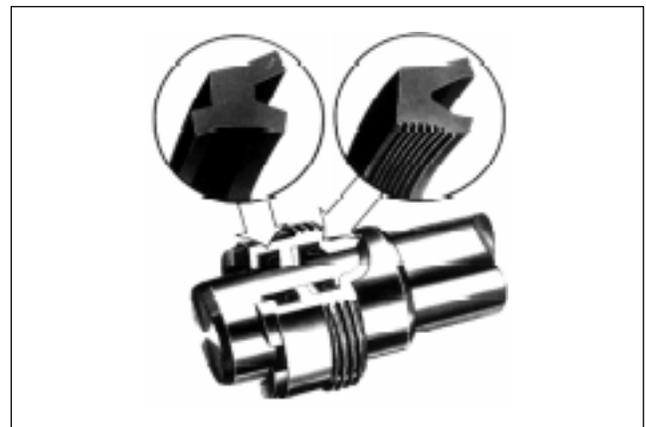
Um tipo comum de guarnição elástica consiste de uma guarnição primária com a lateral dentada em formato de serra na parte interna. As serrilhas contactam a haste e continuamente raspam o fluido, limpando-a. Uma guarnição secundária retém todo o fluido da guarnição primária e ainda previne contra a entrada de sujeiras quando a haste recua.
