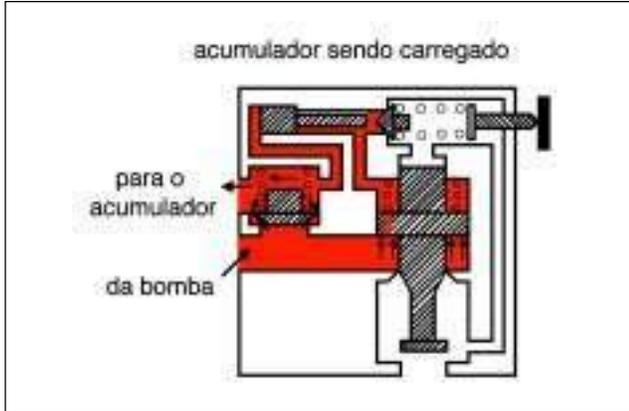
O pistão diferencial se encaixa num furo oposto à agulha da válvula piloto. Durante o tempo em que o acumulador está sendo carregado, a pressão em cada extremidade do pistão diferencial é igual.
