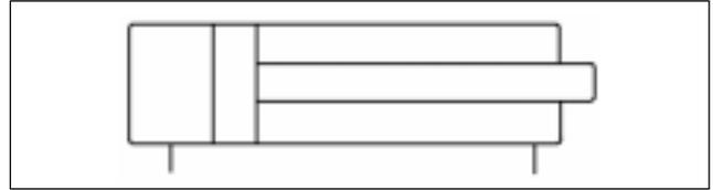
**Cilindro de haste dupla** - Um cilindro com um pistão simples e uma haste ligada a cada lado.
