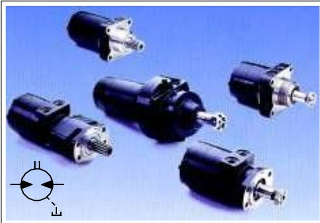
Os motores hidráulicos transformam a energia de trabalho hidráulico em energia mecânica rotativa, que é aplicada ao objeto resistivo por meio de um eixo. Todos os motores consistem basicamente de uma carcaça com conexões de entrada e saída e de um conjunto rotativo ligado a um eixo. O conjunto rotativo, no caso particular do motor tipo palheta ilustrado, consiste de um rotor e de palhetas que podem deslocar-se para dentro e para fora nos alojamentos das palhetas
