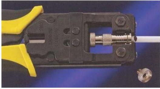
7) Apertar a manopla do alicate de crimpar. Essa ferramenta tem um sistema catraca para soltá-la ao final da compressão.
