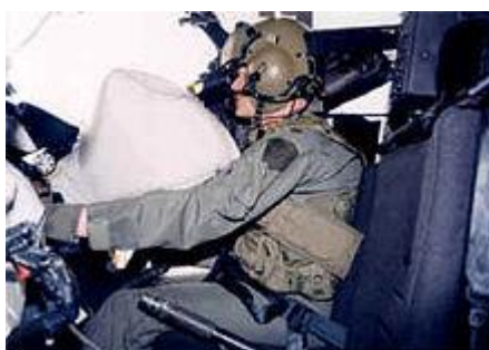
Airbag no helicóptero OH-58 Kiowa.
