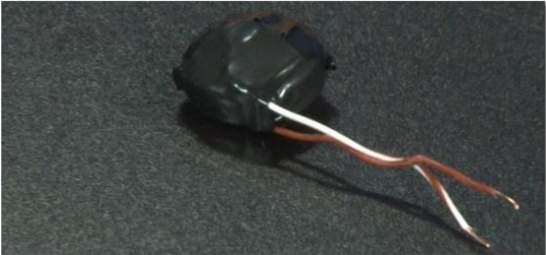
Agora, vamos prender dois fios de cobre no switch. Um pouco de solda para que tudo fique seguro e pronto. Para finalizar, isolamos os contatos com cola quente; isso vai evitar problemas na hora da montagem.
