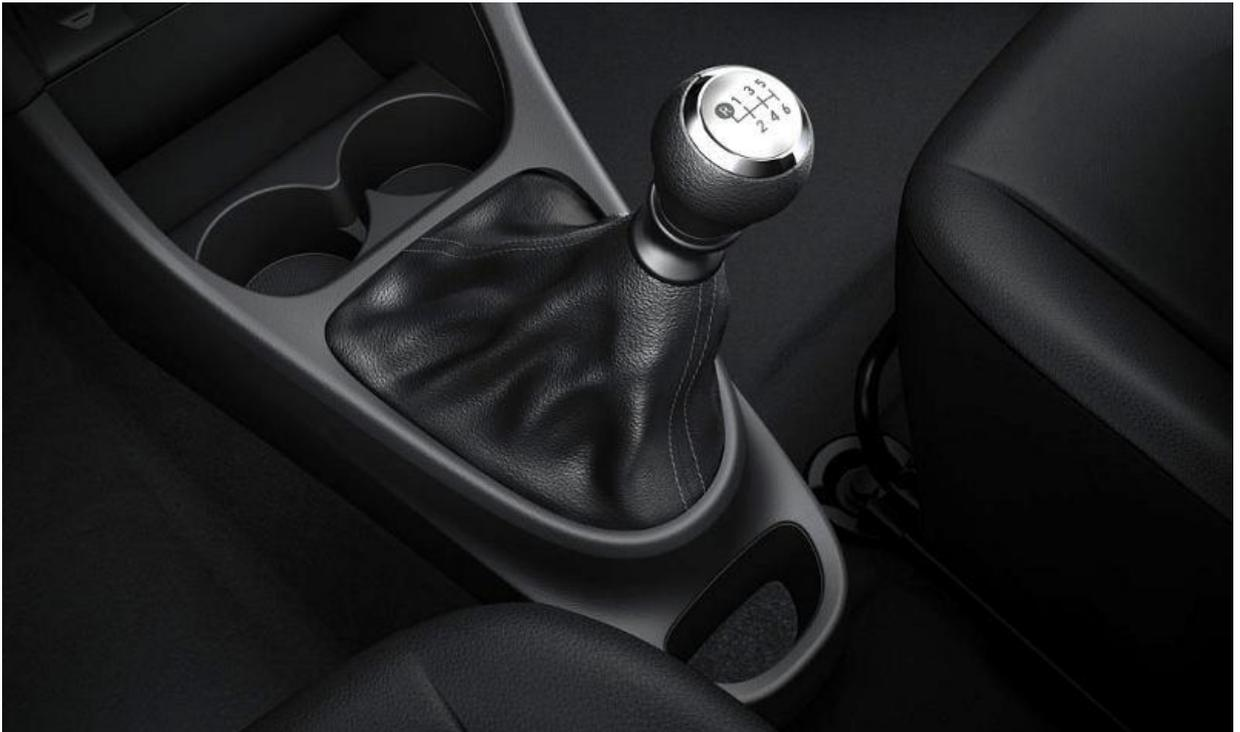
O sistema de transmissão manual possui uma embreagem e uma caixa de marchas. O controle do sistema é feito pelo pedal de embreagem e pela alavanca de câmbio. Já seu acionamento é feito por um pequeno sistema hidráulico e a alavanca do câmbio se liga a um trambulador de acionamento que ativa os engates que estão dentro da caixa de marchas e engatam as marchas selecionadas.
