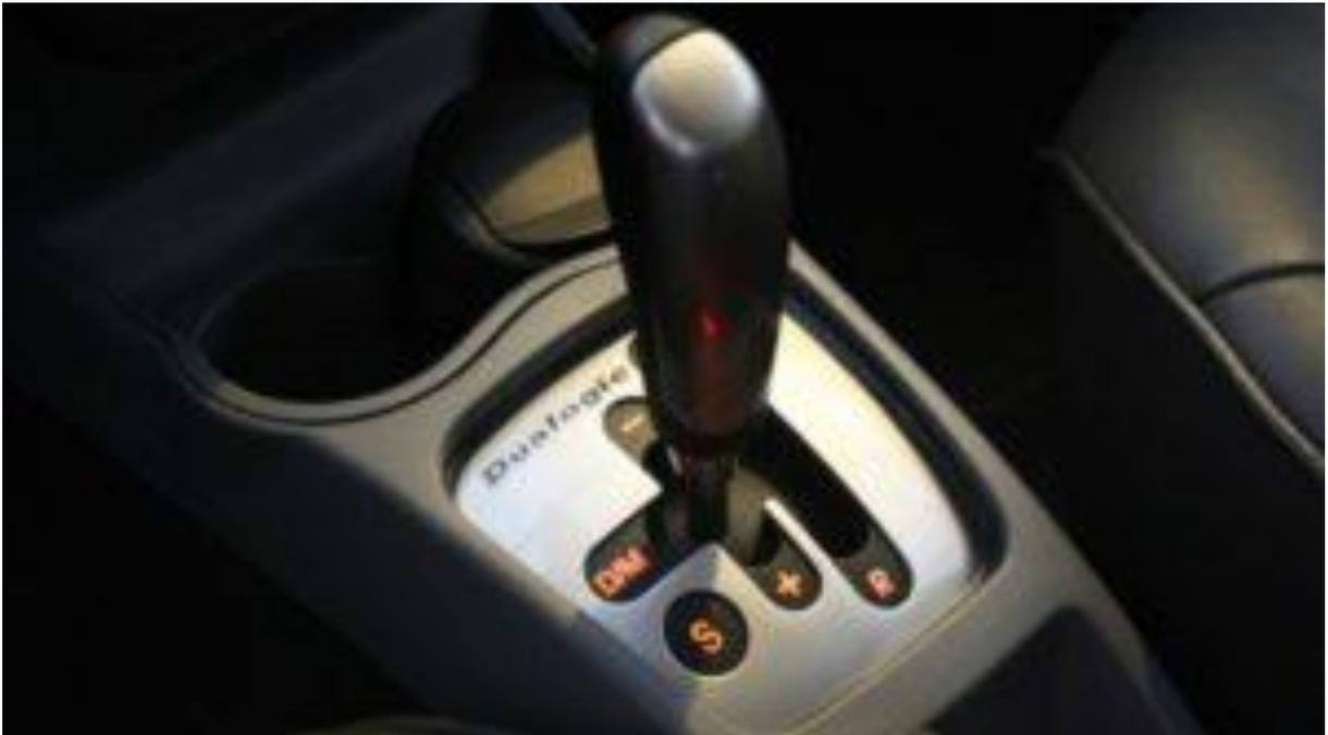
O câmbio automatizado aciona a embreagem e muda de marcha através de um sistema eletrônico de eletroválvulas e bombas hidráulicas controladas por uma ECU. (Módulo)
