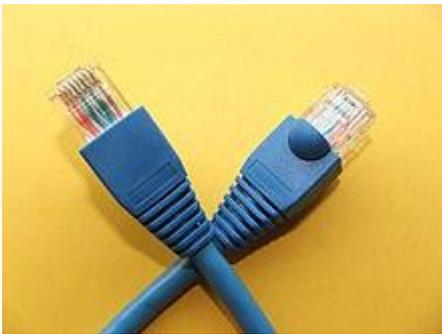
conectores RJ-45 usados para conectar redes ethernet em informática.
