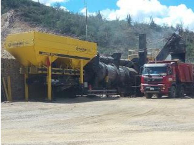
A função principal de uma usina de asfalto é dosar, secar, aquecer e misturar os agregados minerais com o ligante asfáltico (CAP) em alta temperatura, produzindo uma mistura asfáltica homogênea e de qualidade, cumprindo com a formulação. A mistura asfáltica desenvolvida em laboratório, onde o tempo de produção de poucos corpos de prova pode durar um dia inteiro, em uma usina é produzida em altas taxas, acima de 100 toneladas por hora, dependendo do porte do modelo de máquina.
