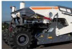
A inclinação do compartimento de corte e mistura é automaticamente corrigida, mantendo o valor designado (em %)
