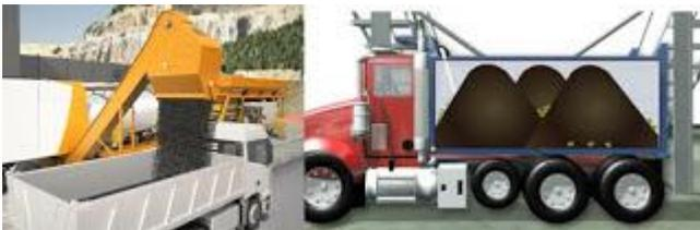
O carregamento em pelo menos três pilhas separadas evita o efeito da segregação no caminhão de transporte.
