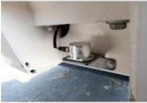
Sensor de inclinação, fixado na parte central do chassi
