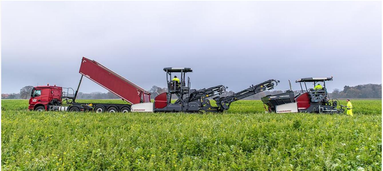
Utilizar um alimentador móvel aumenta a capacidade de pavimentação de maneira geral evitando, ao mesmo tempo, o contato entre o caminhão e a pavimentadora. Ela também proporciona uma temperatura mais homogênea da mistura e melhor uniformidade. A velocidade constante e a qualidade do material pavimentado também melhoram o resultado da compactação.
