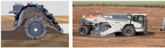
Em uma única passagem ocorre a mistura e homogeneização do material dentro do compartimento de corte.
