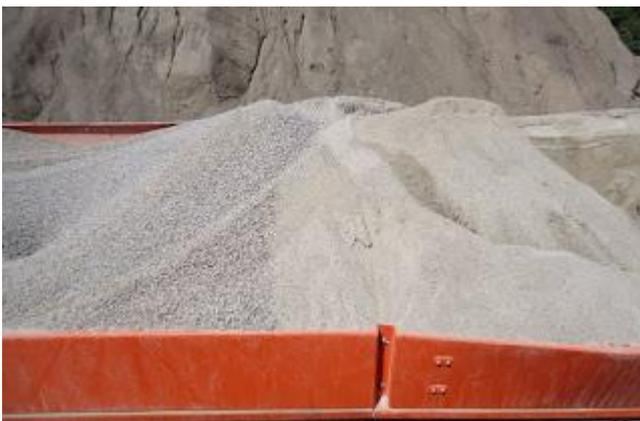
Contaminação entre agregados de diferentes silos da usina de asfalto.
