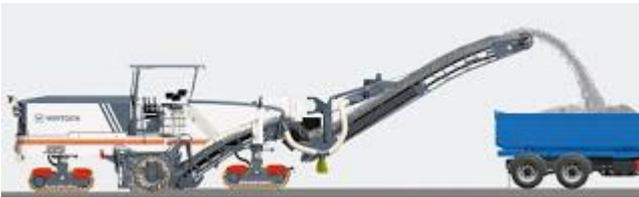
É possível equipar a fresadora de asfalto com tambores de diferentes espaçamentos entre as linhas de corte no pavimento, e conseqüentemente com um número diferente de bits (ferramentas de corte). Além do tambor de fresagem padrão existe as opções de utilização de um tambor econômico com menor número de bits e os tambores de fresagem fina e microfresagem, estes com maior número de bits.
