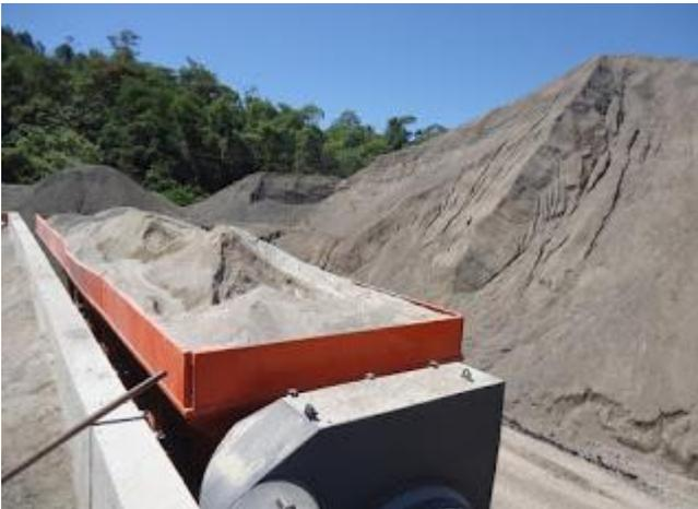
A pilha de agregados deveria ter uma altura mais reduzida, em formato não-cônico, para evitar que os materiais rolem para baixo, não ocorrendo a separação das pedras de maior tamanho.
